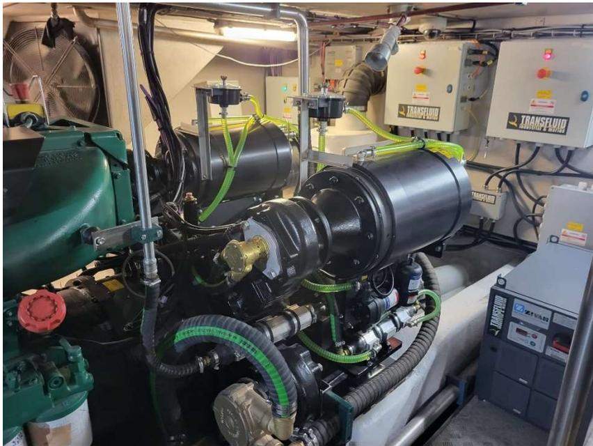
Le système hybride utilisé sur le « Green Calanques » a été fourni par Transfluid et représente un chef-d'œuvre d'ingénierie et d'innovation. Ce système, qui fait partie de la série HM de Transfluid, est conçu pour s'adapter à tout moteur à combustion équipé d'un volant et d'un carter SAE standard. La « voiture électrique » fonctionne à la fois comme moteur électrique en mode électrique et comme générateur électrique en mode thermique.
